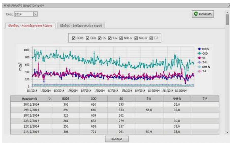
Σχ. 5. Δειγματοληπτικοί έλεγχοι Δεκεμβρίου 2014. Είσοδος ανεπεξέργαστων λυμάτων. (Πηγή: : https://ydatinoskosmos.files.wordpress.com/2015/11/cebdceadceb1-ceb5ceb9ceb9cf8ccebdcceb1-8.png )
