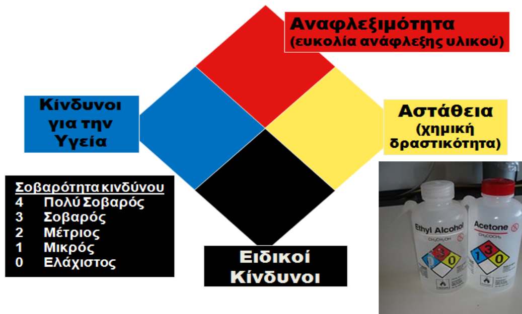
Εικόνα 5: Συστήματα επισήμανσης κινδύνων NFPA. Περιέχονται συγκεκριμένοι κίνδυνοι ανά χρωματική κατηγορία.
